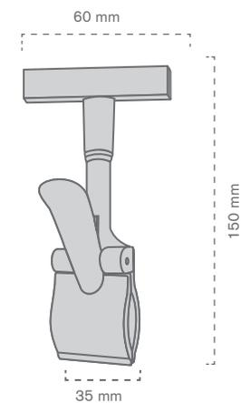
Pinza portafundas disponible en diversos colores. Este modelo de pinza está especialmente indicado para barras de hasta 30 mm. de diámetro, permitiendo colocar fundas en su parte superior (tamaño máximo A4).
