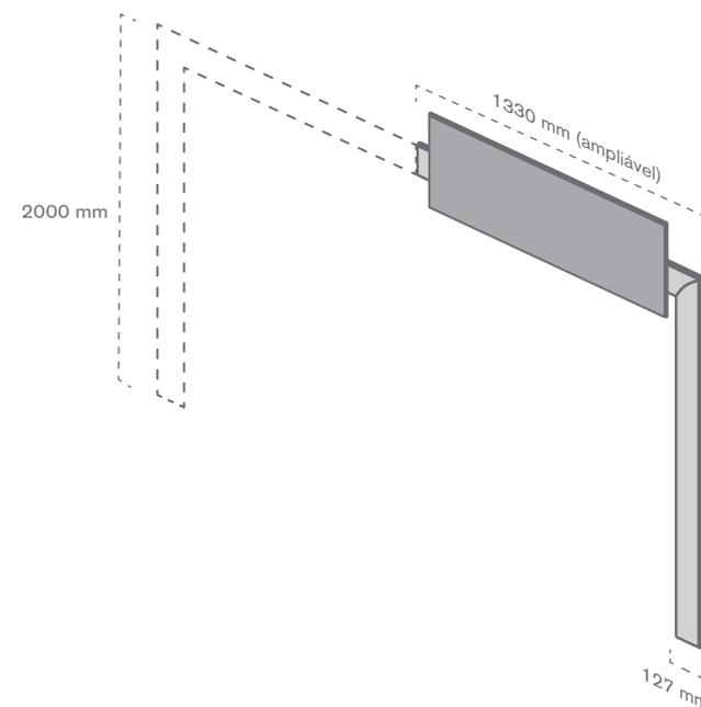
Marco de estrutura metálica multi módulo. Este modelo tem a vantagem de se poder ampliar em múltiplos de 1330 mm. (tamanho dos módulos de gôndola).
