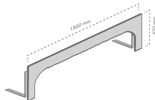
Marco de topo especialmente indicado para delimitar ou destacar secções. Esta peça fixa-se ao linear com suportes traseiros que se ajustam à prateleira superior do módulo da gôndula.
