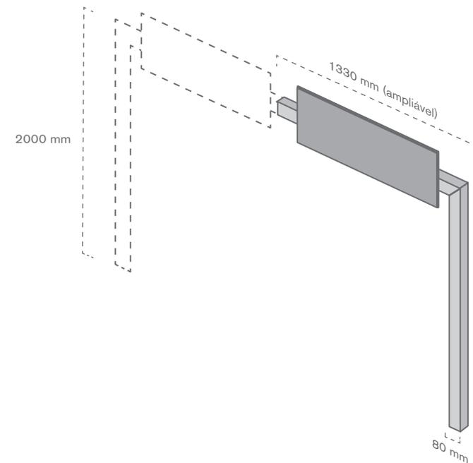
Marco multi módulo fabricado em PVC de alto impacto e decorado com vinil laminado. Este modelo permite a ampliação até à zona pretendida acrescentando secções de igual tamanho ao dos módulos da gôndola.
