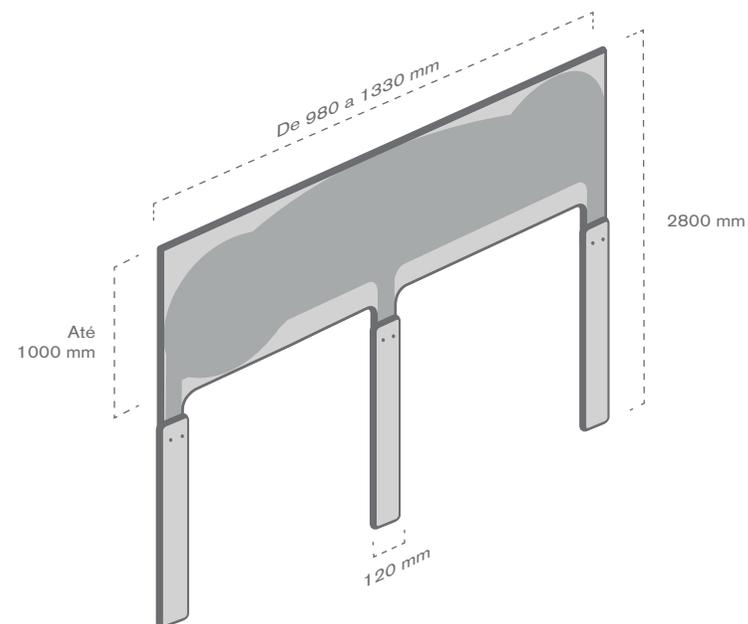
O marco multi módulo baseia-se nas características dos modelos anteriores com a vantagem de adicionar novos módulos, que permitam delimitar a zona do linear desejada.
