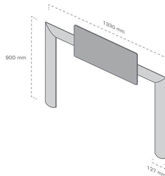
Marco de estrutura metálica específica para delimitar gôndolas médias. Permite a incorporação de uma placa de PVC espumado personalizada na parte superior.
