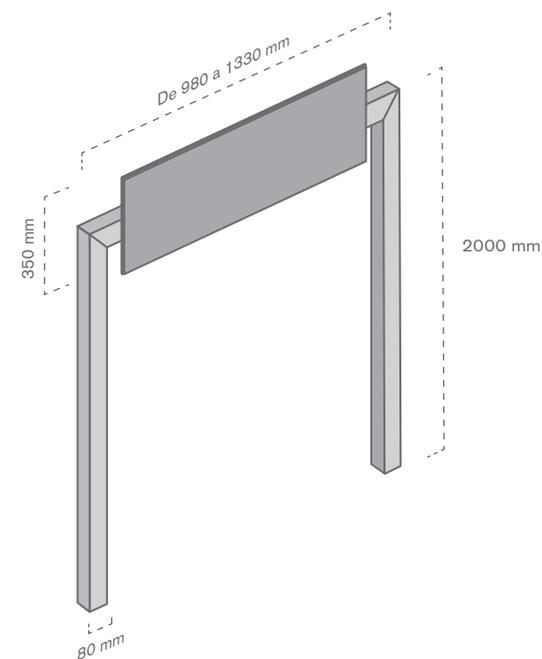
Marco fixo para um módulo de gôndula. Este modelo é fabricado em PVC de alto impacto e decora-se com vinil laminado, permitindo assim a impressão de qualquer tipo de desenho.
