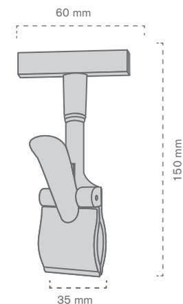
Pinça porta bolsas disponível em várias cores. Este modelo é indicado para barras até 30 mm. de diâmetro, permitindo colocar bolsas na parte superior (tamanho máximo A4).
