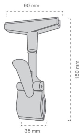
Pinça fixa caixilhos disponível em várias cores. Este modelo é indicado para barras até 30 mm. de diâmetro, permitindo colocar um caixilho na parte superior.
